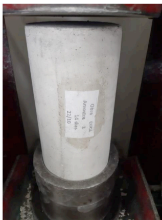
Figura 9: Corpos de prova capeados e posicionados na prensa
