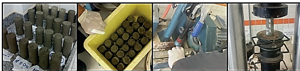
Figura 2 – Moldagem, regularização e rompimento dos corpos-de-prova.
