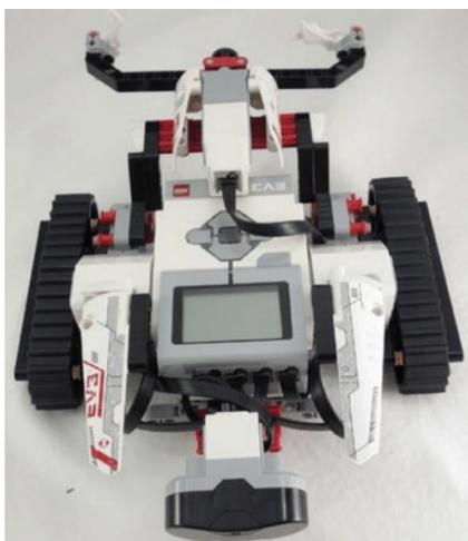
Figura 3 – Rôbo LEGO Mindstorms EV3, modelo Track3r.
