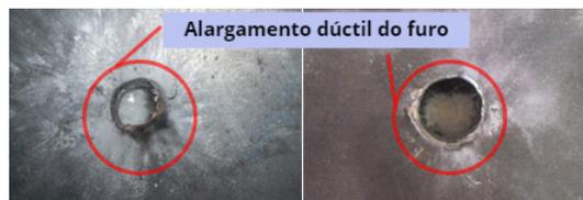
Figura 20: placas de aço dos módulos perfuradas.
