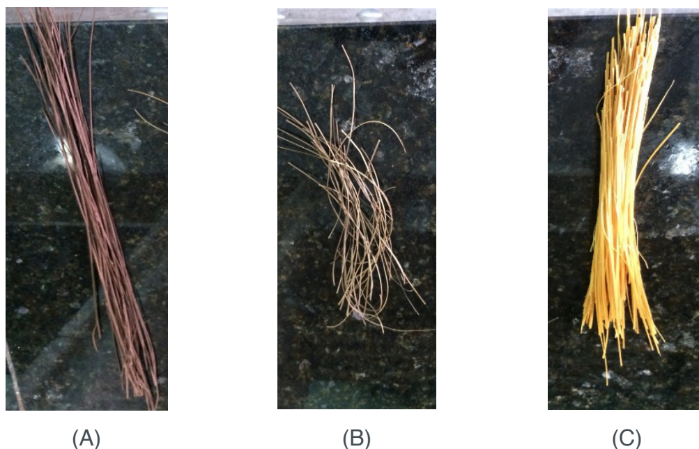
Figura 2- Fibras de Piaçava sem o tratamento (A), mercerizada (B) e tratada com peróxido alcalino (C), respectivamente.
