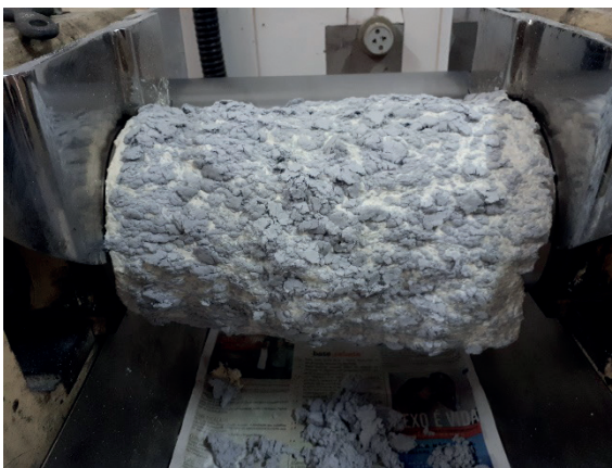
Figura 3 – Incorporando o resíduo de couro (carga)
