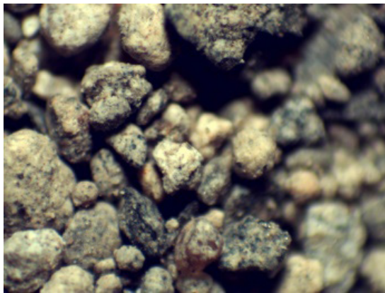
(a) Agregado miúdo ELD (45x)
