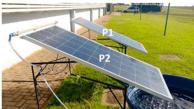
Figura 2 – Sistema Fotovoltaico solar com e sem resfriamento à água
