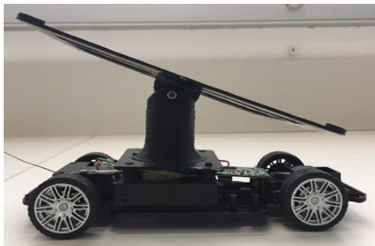
Figura 3 - Carrinho solar com painel orientável
