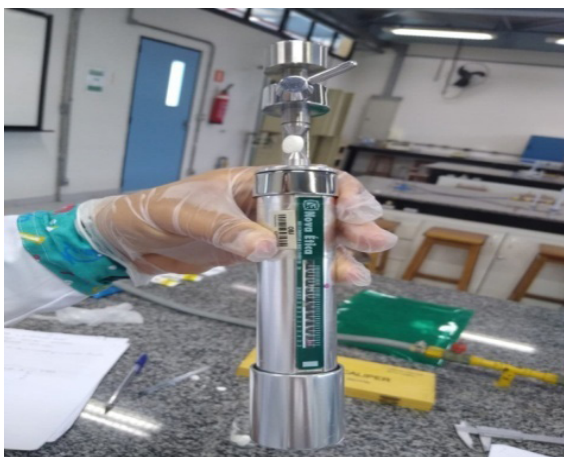
Figura 3: Durômetro sendo utilizado.
