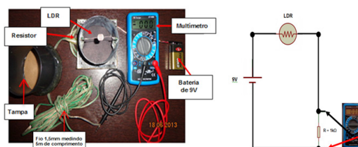
Figura 1: Foto do sensor após montagem e antes da realização dos testes.
