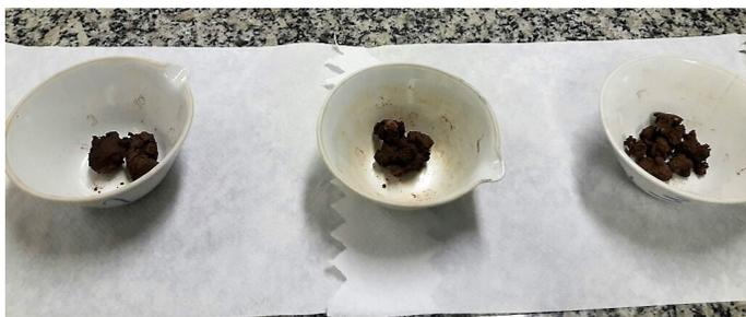
Figura 11 - Amostras de lodo depois da secagem
