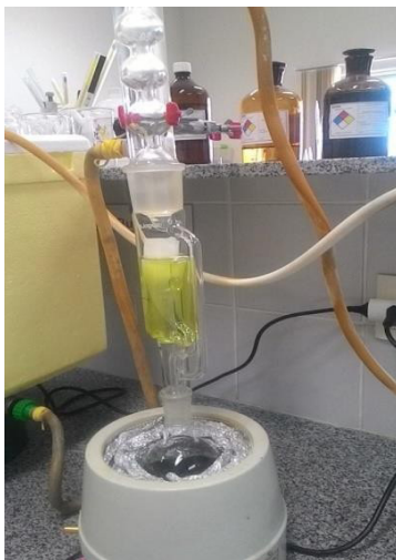
Figura 1. Extrator soxhlet montado realizando o processo com espinheira santa. (autoria própria)
