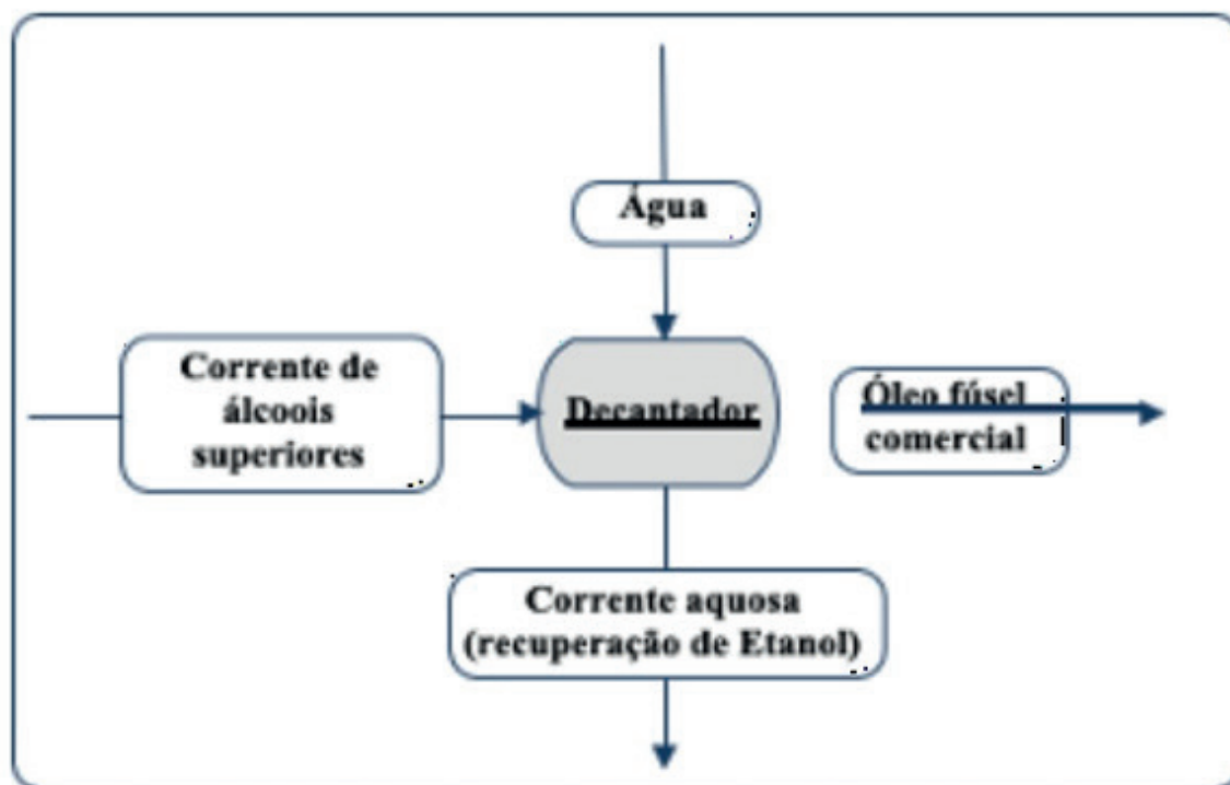
Figura 1. Decantador onde ocorre a lavagem do óleo fúsel.
