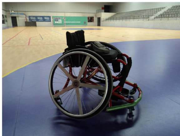
Figura 2-28 - Cadeira de rodas do basquete com cubo PowerTap® para medição de parâmetros como potência e velocidade, respeitando-se a especificidade e interação utilizador-cadeira.
