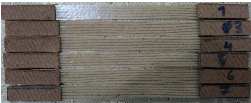
Figura 6. Corpos de prova para o ensaio de tração do laminado.
