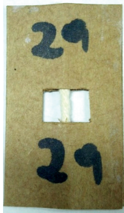
Figura 3. Modelo de corpo de prova para ensaio individual da fibra.
