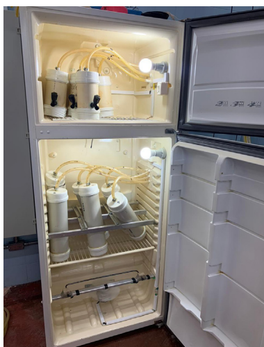
Figura 2 – Interior do biodigestor com os reatores
