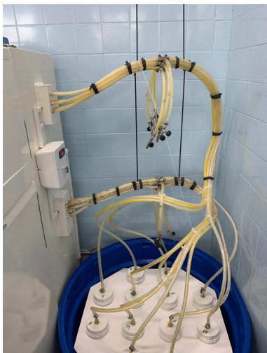
Figura 3 – Mangueiras de transporte de gás e gasômetros
