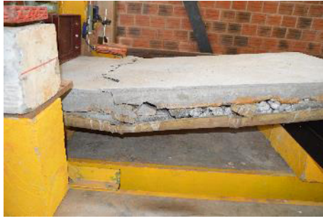
Figura 18 - Ruptura da capa de concreto, laje com nós. Fonte: Elaborado pelos autores.
