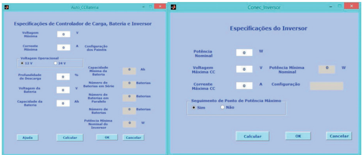
Figura 11. Interface da etapa do cálculo de configurações elétricas da bateria, controlador de carga e inversor do sistema autônomo de placas fotovoltaicas no Software de Energia Solar.
