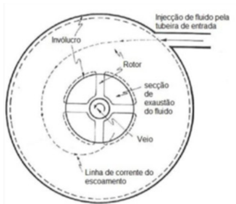
Figura 4 - Trajetória do fluido na turbina de Tesla.
