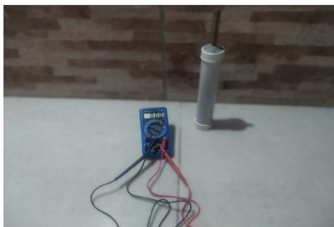
Figura 2 – Eletrodo de referência e voltímetro utilizados no ensaio de potencial de corrosão
