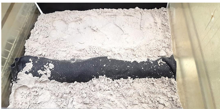
Figura 2 – Material para recobrimento da tubulação com agregado miúdo
