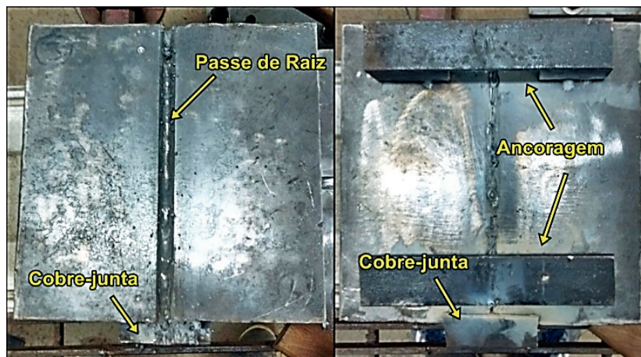
Figura 6 – Visão de topo e inferior das chapas chanfradas com esquema de ancoragem.
