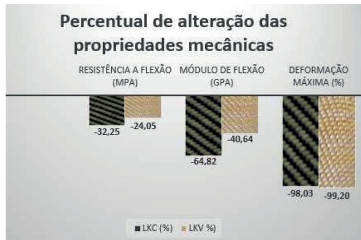
Figura 11 - Percentual de alteração das propriedades mecânicas após absorção
