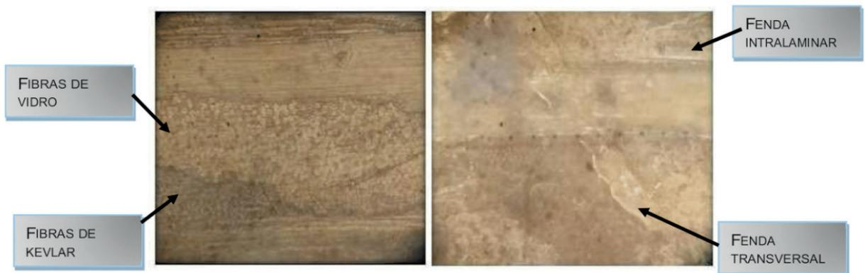
Figura 14 - Macroscopia ótica (200  $\mu\text{m}$ ) dos corpos de prova LKV
