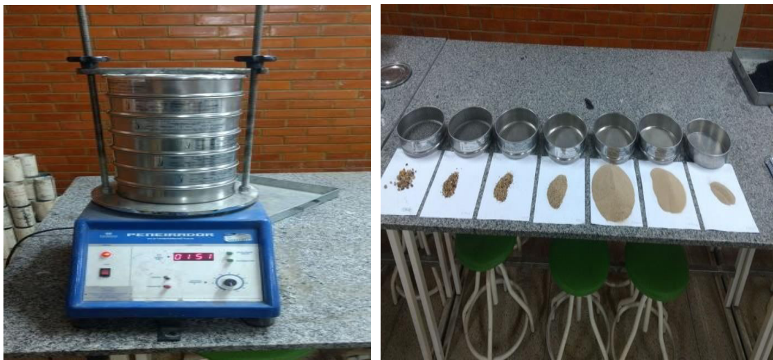
Figura 3 – Agitação mecânica e Pesagem do material retido em cada peneira. (Autor (2017))
