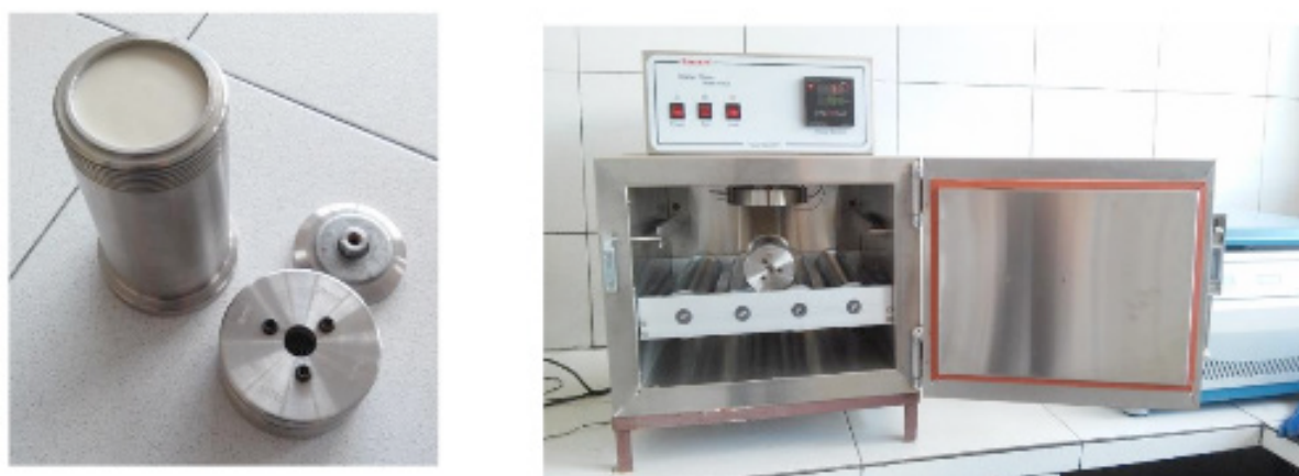
Figura 2 –(a) Célula de envelhecimento, (b) Equipamento Fann Estufa Rotativa Roller Oven. Fonte: Laboratório de fluidos do IFBA, 2016.
