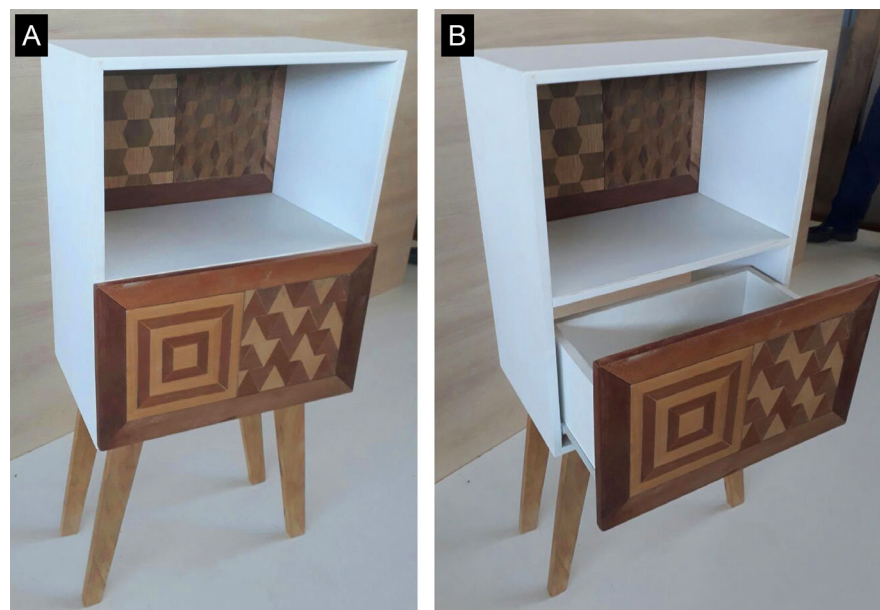
Figura 6: Móvel de apoio finalizado: A) com a gaveta fechada, detalhe da moldura de madeira que dá acabamento aos encaixes dos módulos; B) com a gaveta aberta.
