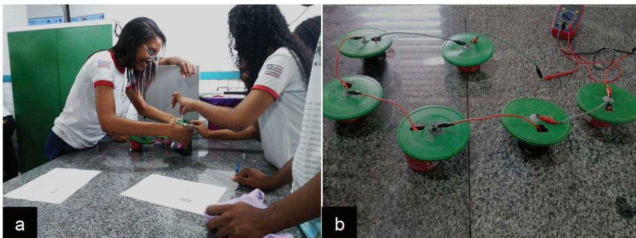
FIGURA 1. a) Alunos confeccionando a bateria a partir de materiais alternativos; b) Bateria confeccionada.
