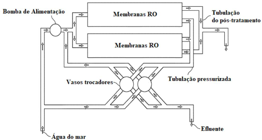
Figura 2: Sistema de trocador de pressão.
