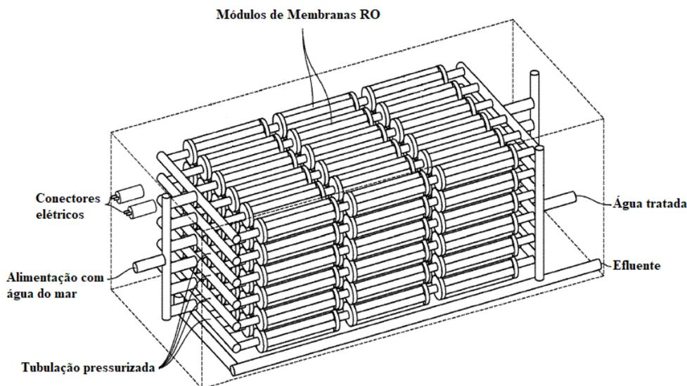
Figura 4: Sistema de trocador de pressão em contêiner
