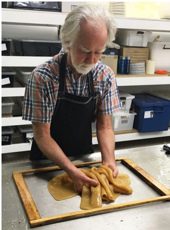
Figura 1 – Biotêxtil de kombucha sendo esticado para secar
