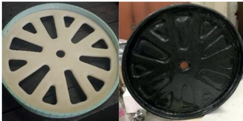
Figuras 12 e 13 – Roda: escopo artesanal de Divinycell e peça final laminada, respectivamente
