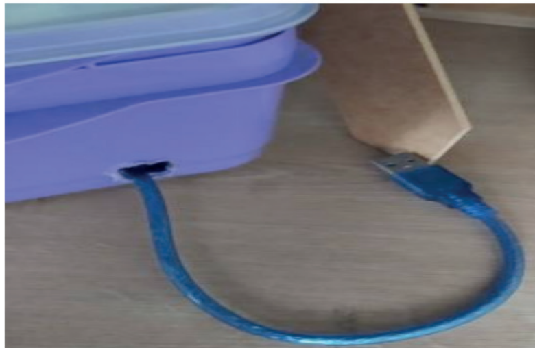
Figura 8: É aberta uma saída na parte inferior para o cabo de energia da placa Arduino.
