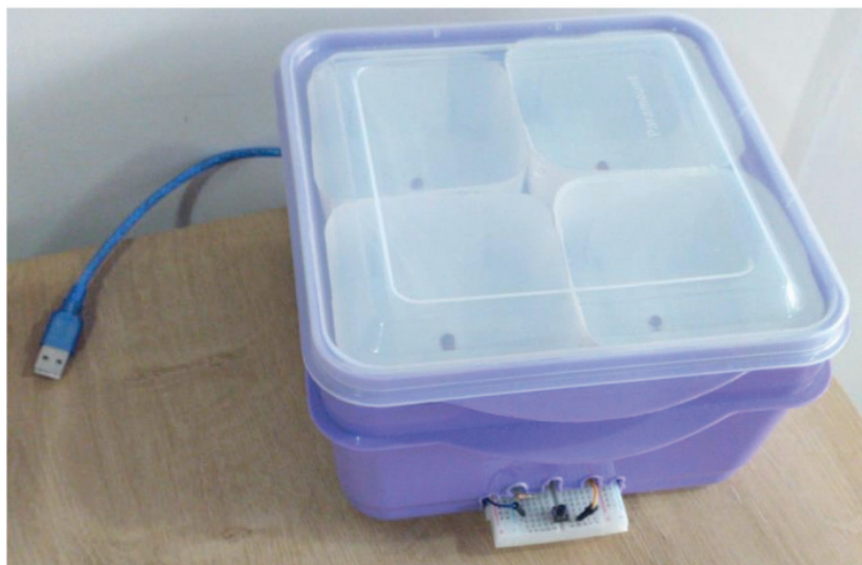
Figura 9: dispositivo final, mostrando na parte superior a quantidade de divisões, neste caso quatro, com abertura para cada LED.
