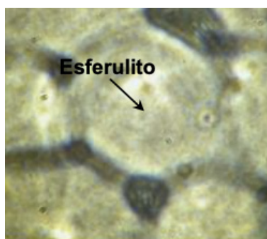
Figura 1: Imagem microestrutural do PVDF evidenciando a formação da estrutura esferulítica.
