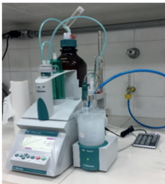
Figura 3. Esquerda: Titulador automático Titrino 702 SM \Omega Metrohm durante a síntese de LDH. Direita: Forno Mufla EDG1800 utilizado no tratamento térmico dos LDHs estudados.
