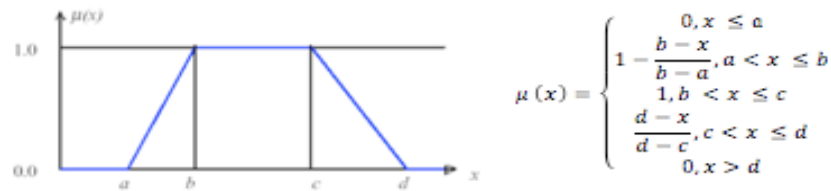
Figura 2: Representação de uma função de pertinência trapezoidal formada pelas variáveis a, b, c e d
