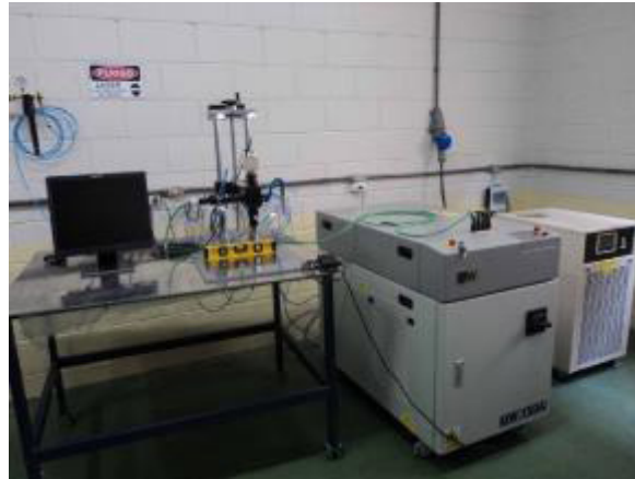
Figura 1 – Sistema laser Nd:YAG pulsado, modelo UW-150A United Winners, montado no Laboratório de Soldagem
