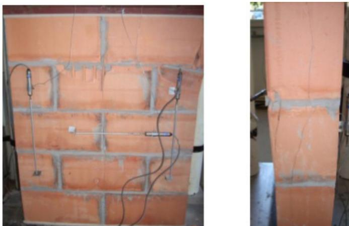
Figura 14 - Modo de ruptura das pequenas paredes cerâmicas da série Ce (não grauteadas)
