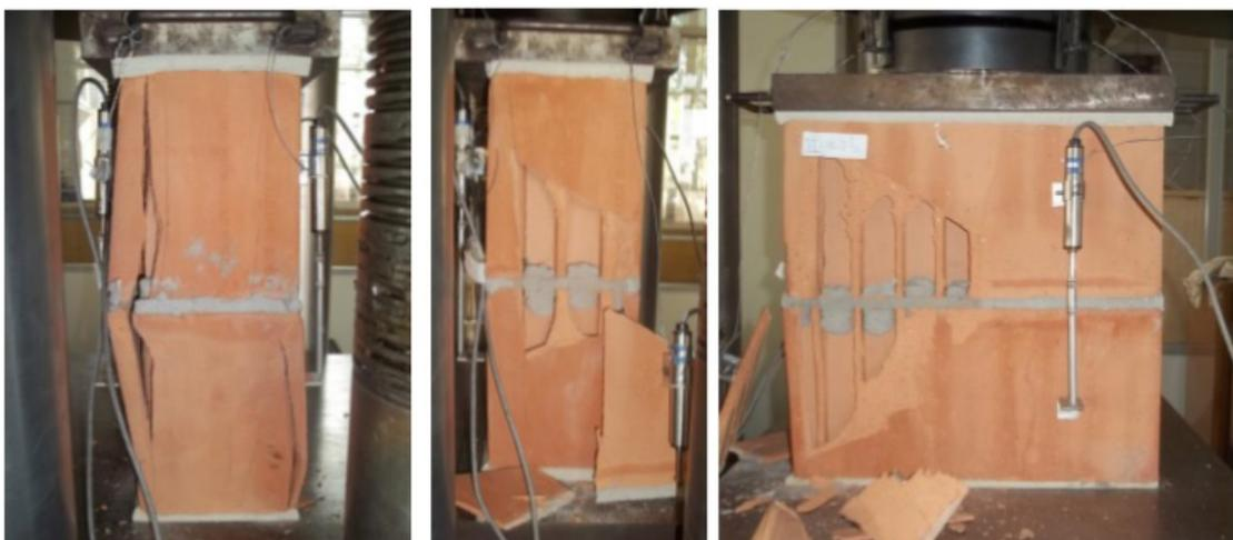
Figura 6 - Modo de ruptura dos prismas cerâmicos de dois blocos da série CeG14 (graute G14)
