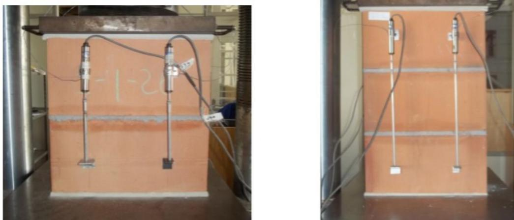
Figura 3 - Esquema de ensaio da resistência à compressão dos prismas de blocos cerâmicos
