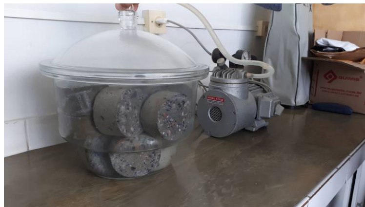
Figura 1: Corpos de Prova no vácuo, antes da realização do ensaio no laboratório de Química da Universidade Católica de Pernambuco. (Fonte: Autores, 2019).
