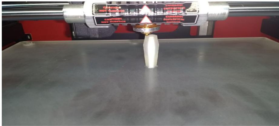
Figura 5 - Modelo em processo de impressão.
