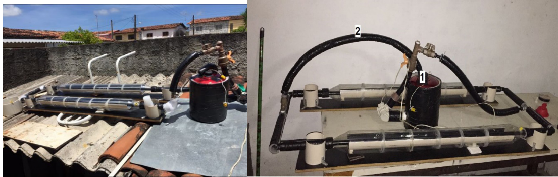
Figura 10: (a) Arranjo em série. (b) Arranjo em paralelo.
