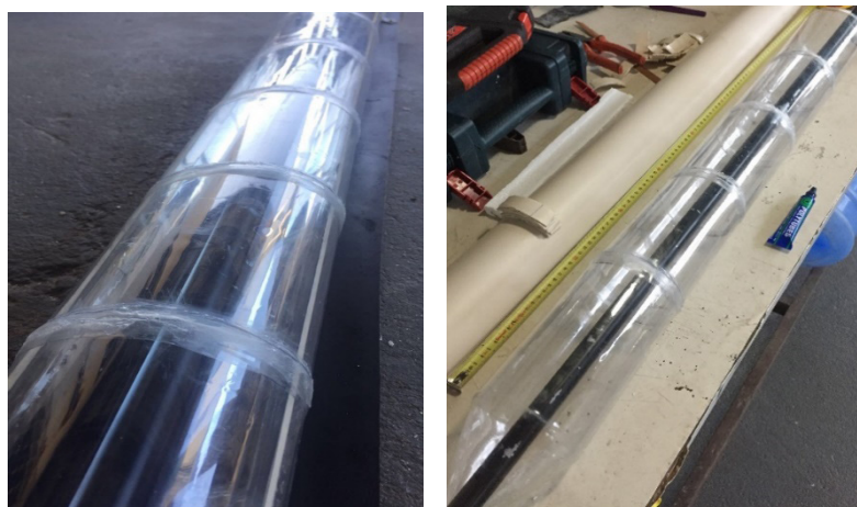
Figura 4: (a) Colagem das garrafas PET. (b) Montagem das tubulações.
