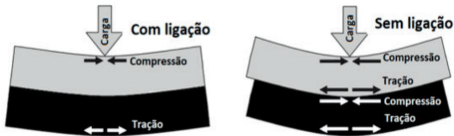
Figura 1: Comportamento do pavimento sob carga vertical
