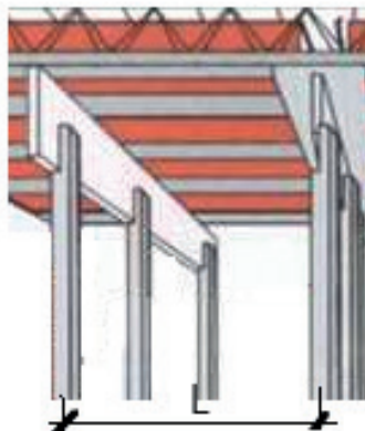
Figura 8 - Distância entre guias de apoio
