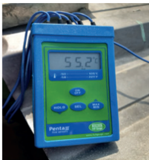
Figura 6 – Aparelho de coleta de temperatura, modelo penta III da Full Gauge
