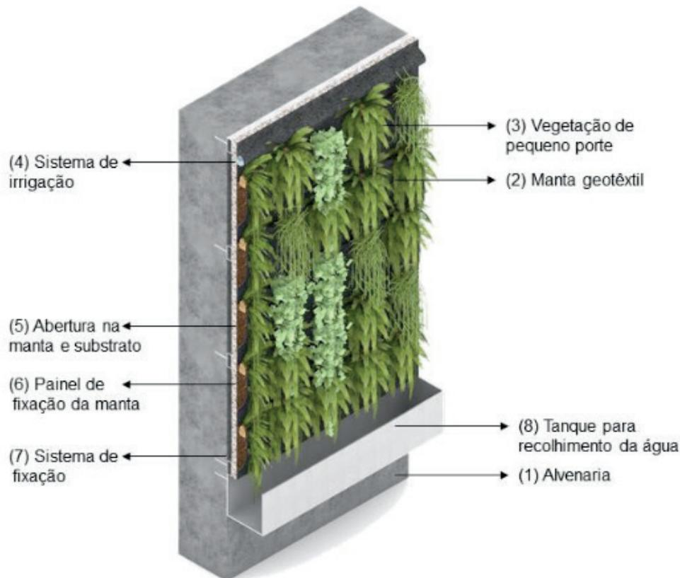
Figura 7 – Representação esquemática de uma parede verde referente ao sistema intensivo contínuo.
