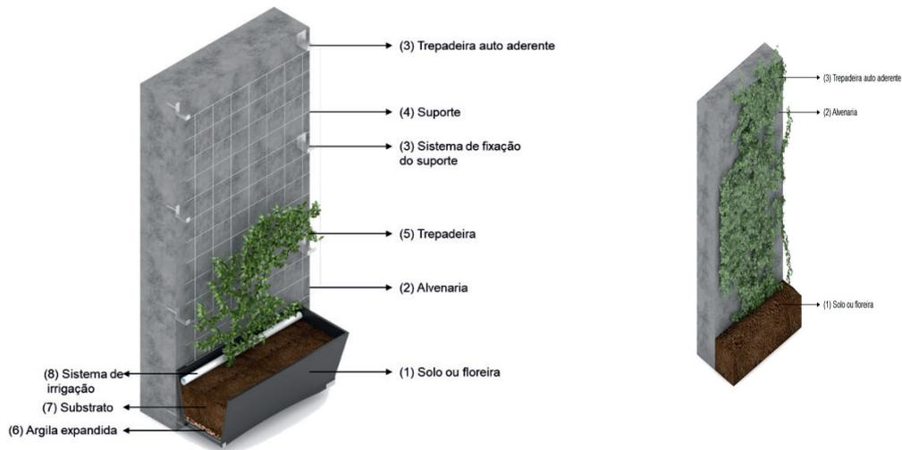
Figura 5a e 5b – Representação esquemática de uma parede verde referente ao sistema extensivo direto e indireto.
