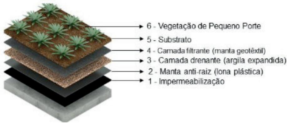
Figura 2 – Representação esquemática de um módulo de cobertura verde referente ao sistema extensivo contínuo.
