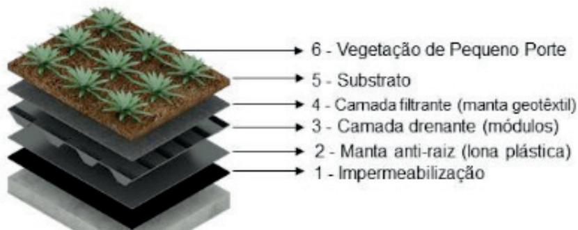
Figura 3 – Representação esquemática de um módulo de cobertura verde referente ao sistema extensivo modular.
