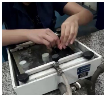
Figura 4: Processo para tirar impurezas através de lixas.
