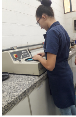
Figura 6: Polimento das amostras Fonte: Autora, 2018.
