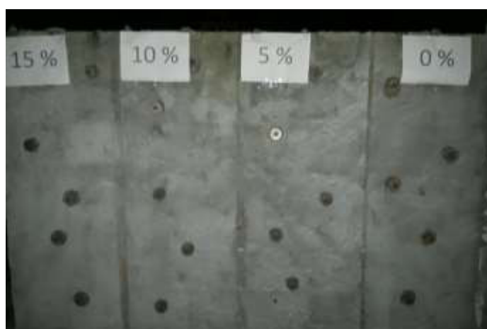
Figura 2 – Painéis com as Famílias de chapisco
