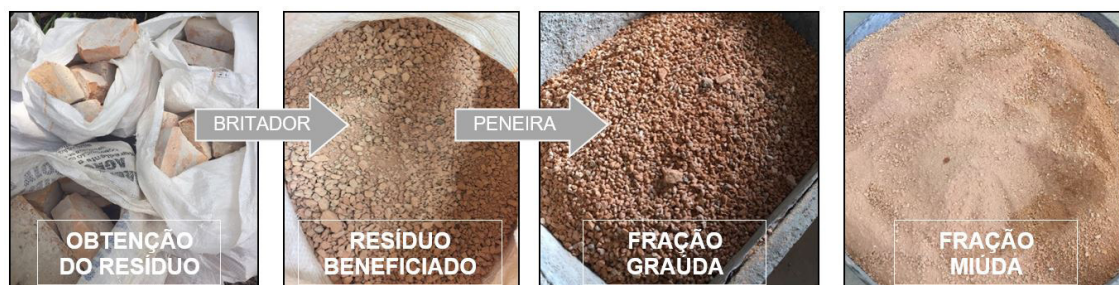
Figura 2 – Processo de beneficiamento do resíduo de cerâmica vermelha
