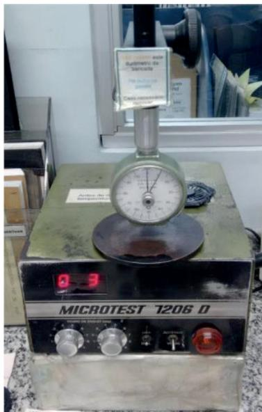
Figura 4. Equipamento Durômetro
