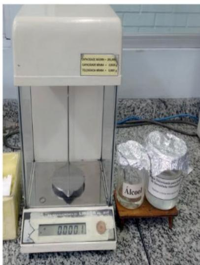
Figura 6. Equipamentos para ensaio de densidade Hidrostática
