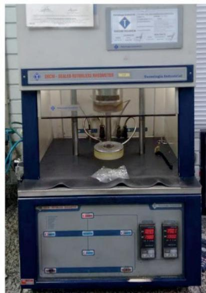
Figura 5. Equipamento Reômetro
