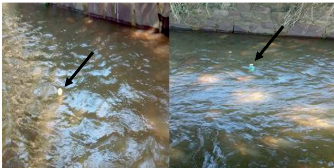
Figura 2 - Aferição de tempo através do método flutuador (esquerda: bolinha de polietileno e direita: garrafa pet de 200 ml)
