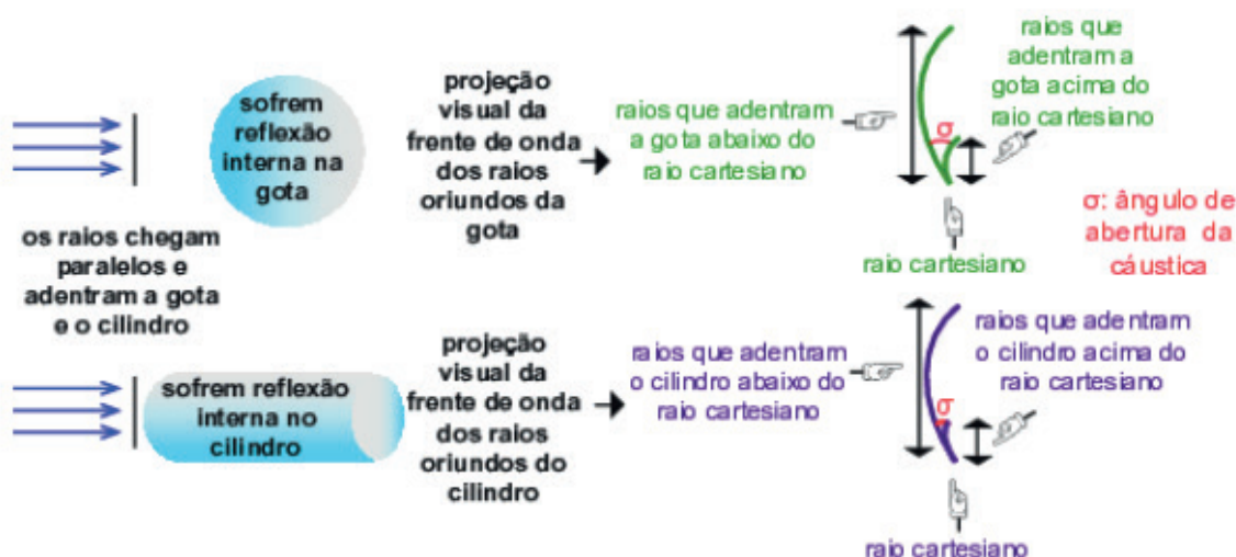
Figura 7. Esquematização da cáustica formada na gota e no cilindro. Fonte: Autoria própria.
