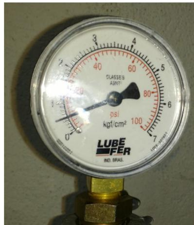
Figura 3 – Manômetro de escala de 0 a 7 kgf/cm<sup>2</sup> (Próprio autor).
